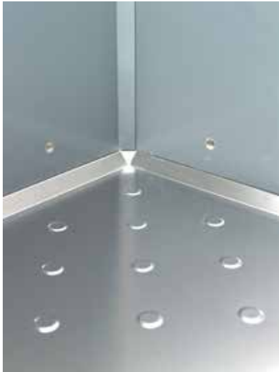
vollhygienischer Edelstahlboden DIN 1.4509 in kreisverpresst, rutschfest genoppt Ausführung, Flächenlast 2000 kg/m 2
