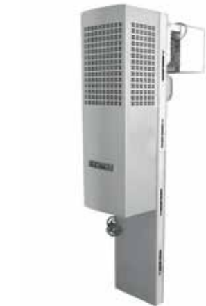
Sonderzubehör: im Wandpaneel steckerfertig vorinstalliertes Kälteaggregat inkl. Feuchtraumleuchte, wodurch der zeitaufwendige Ausschnitt für ein Kälteaggregat entfällt. Servicefreundlich mit automatischer Tauwasserverdunstung und Heißgasabtauung.
