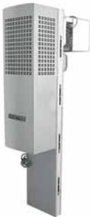
Sonderzubehör: im Wandpaneel steckerfertig vorinstalliertes Kälteaggregat inkl. Feuchtraumleuchte, wodurch der zeitaufwendige Ausschnitt für ein Kälteaggregat entfällt. Servicefreundlich mit automatischer Tauwasserverdunstung und Heißgasabtauung.
