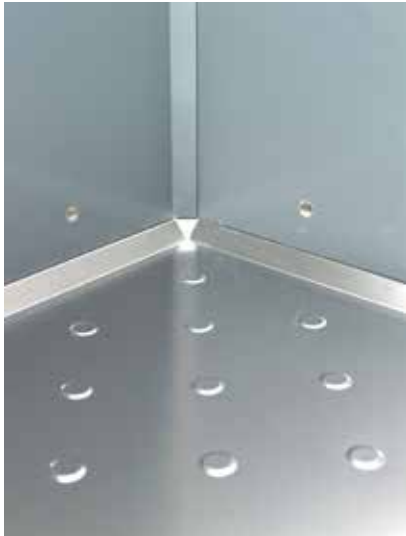
vollhygienischer Edelstahlboden DIN 1.4509 in kreisverpresst, rutschfest genoppter Ausführung, Flächenlast 2000 kg/m 2
